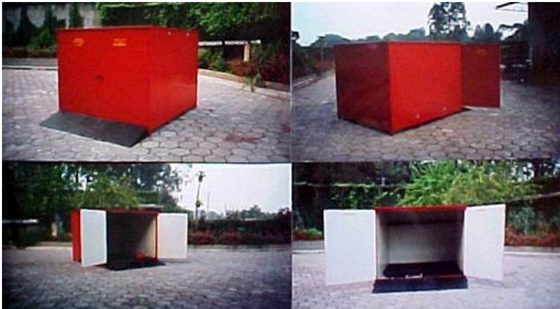
Armário para 8 tambores com diques de contenção
